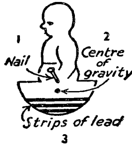
1 ஈயம். 1. ஆணி. 2. ஈர்ப்பு மையம் 3. ஈயத் தகடு. படம் 6. படம் 7.
